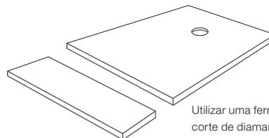
Utilizar uma ferramenta de corte de diamante
