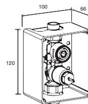
Caixa de pré-instalação do urinol
