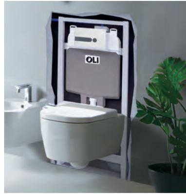
O sistema de instalação Autoportante OLI é composto por estruturas metálicas com pintura epóxida, de fixação apenas ao chão, para a instalação de **louça sanitária suspensa** em paredes ligeiras.
