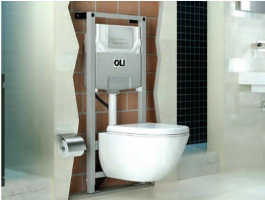
O sistema de instalação Sanitarblock é composto por estruturas metálicas com pintura epóxida, de fixação em paredes de alvenaria e ao chão, para a instalação de **louça sanitária suspensa**, estando também preparado para aplicação em calha técnica de suporte a paredes ligeiras. A estrutura regulável em altura, os elos de fixação rápida e a regulação da posição da curva de descarga em profundidade proporcionam uma enorme facilidade de aplicação nas mais variadas situações.
